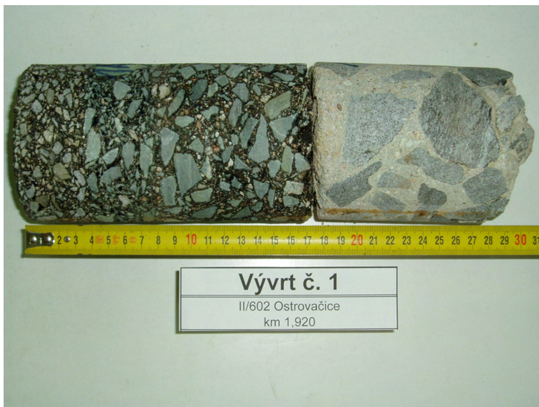
Foto č. 1 – Detail vývrtu č. 1
